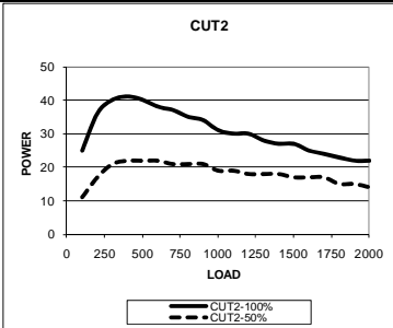
Diagramm der maximalen und durchschnittlichen Leistung mit Wechsellast 100-2000Ω CUT2
